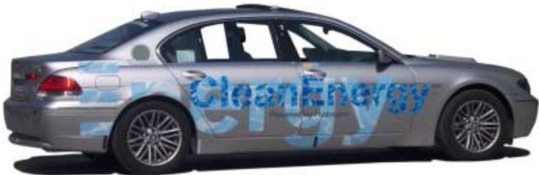
Erprobungsfahrzeug: BMW 7er mit Wasserstoffverbrennungsmotor
