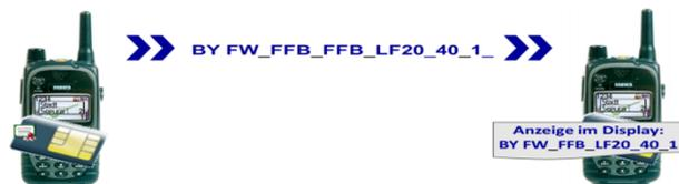
Bei jeder Verbindung wird die OPTA vom sendenden an jedes empfangende Funkgerät übertragen, wobei nur die Alias- OPTA im Klartext auf dem Display angezeigt.
