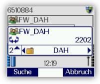
Der Gruppenwechsel kann durch kurzes Drücken der Mode-Taste aufgerufen werden.
