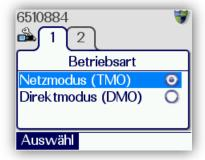
Der Wechsel Netzbetrieb / Direktbetrieb erfolgt i. A. über die seitliche Funktionstaste. Es wird immer auf die zuletzt aktive Gruppe der Betriebsart gewechselt.
