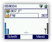
Befindet sich das Endgerät im Sendebereich eines Repeaters wird dies durch ein zusätzliches Symbol für den Betriebszustand angezeigt.
