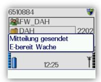
Status kann über langes Drücken der Zifferntasten (Belegung vergleichbar analogem FMS-System) gesendet werden.
