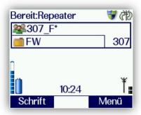
Sofern das Gerät mit einer Repeater-Lizenz ausgestattet ist, wird ein aktiver Repeater-Betrieb ebenfalls über ein zusätzliches Symbol im Betriebszustand sowie über eine Textmitteillung in der obersten Display-Zeile signalisiert.
