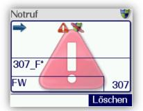
Durch 2 Sekunden langes Drücken der Notruftaste wird ein Notruf ausgelöst.
