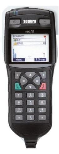
Tastenbelegung ist identisch zum HRT Gerät. Der fehlende Drehregler (Lautstärke) ist durch zwei Tasten (+/-) auf der Oberseite ersetzt.
