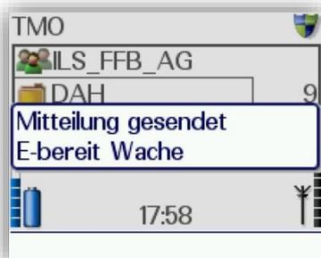
Statusmeldungen können über langes Drücken der Zifferntasten (Belegung vergleichbar analogem FMS-System) gesendet werden.
