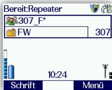
Sofern das Gerät mit einer Repeater-Lizenz ausgestattet ist, wird ein aktiver Repeater-Betrieb ebenfalls über ein zusätzliches Symbol im Betriebszustand sowie über eine Textmitteilung in der obersten Display-Zeile signalisiert.
