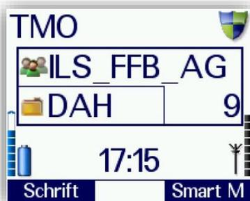
Mittels der linken Kontexttaste kann die Schriftgröße geändert werden.
